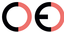
Marcatura CE contraffatta (troppo distante)
